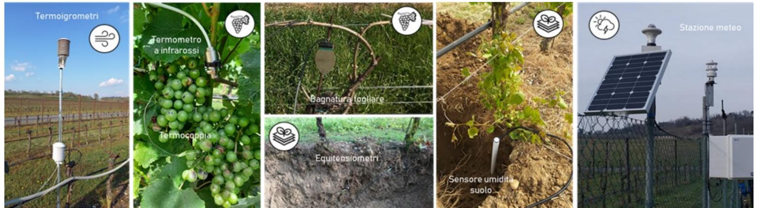
All'interno dei filari sperimentali sono installati sensori per il **monitoraggio in continuo di aria, pianta e suolo**. Al di fuori dei filari è installata una stazione per il **monitoraggio agro-meteorologico**.
